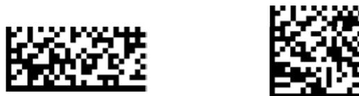
Abb. 7: Rechteckiges und quadratisches GS1 DataMatrix-Symbol (stark vergrößert). Beide Symbole enthalten dieselben Daten.
