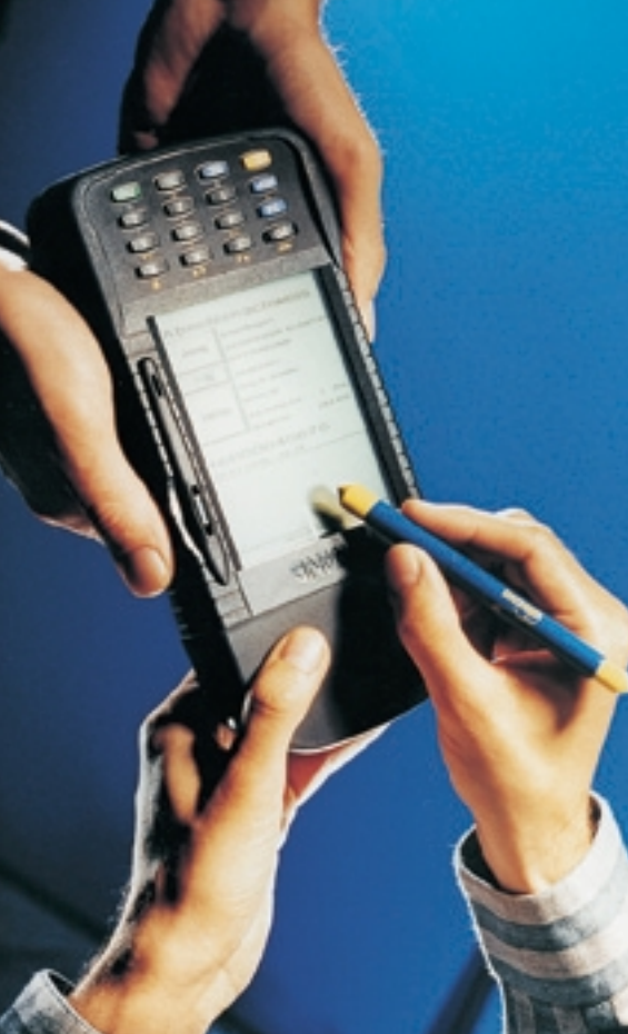
Abb. 6: Der Empfänger quittiert den Wareneingang direkt auf dem Bildschirm des Pen Key.
