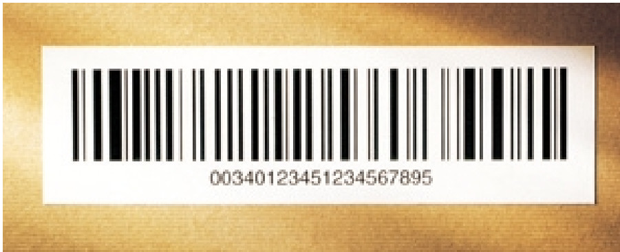
Abb. 1: Die Nummer der Versandeinheit (NVE) dient der eindeutigen Identifikation einer physischen Transporteinheit.
