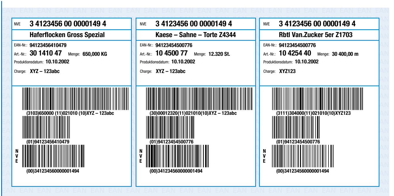
Abb. 2: EAN 128-Transportetiketten für Rohstoff in Kilogramm, Verpackung in Stück und Verpackung in Metern
