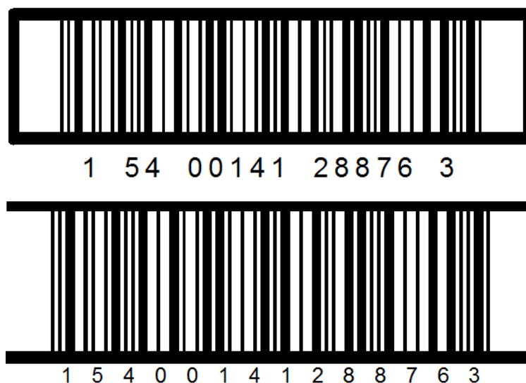
Abbildung 5.3.2.4-1. Beispiele von Trägerbalken
