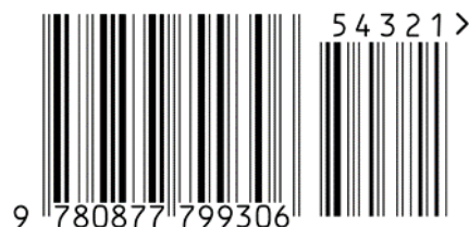
Abbildung 5.2.2.5.2-2. EAN-13 Strichcode mit einem fünfstelligen Zusatzsymbol
