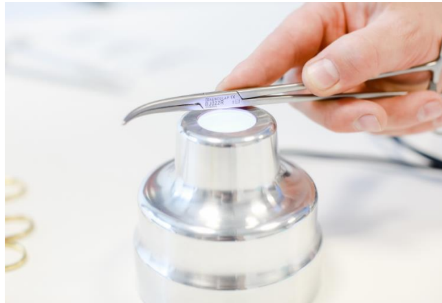
Abbildung 10.18.2-2. Scannen eines GS1 DataMatrix Codes von einem wiederaufbereitem Instrument
