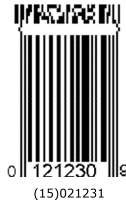
Abbildung 7.8.6.3-2. Beispiel eines Composite Symbols (GTIN im UPC-E, Mindesthaltbarkeitsdatum in der Composite Component verschlüsselt)
