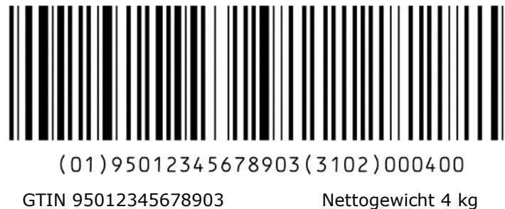
Abbildung 7.8.6.1-2. In einem GS1-128 Symbol verkettete Daten
