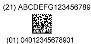
Abbildung 2.6.14-4. Beispiel der Verschlüsselung einer GTIN AI (01) und Seriennummer AI (21) im GS1 DataMatrix
