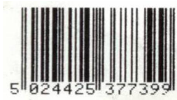
Abbildung 5.12.5.12-1. Symbol mit Problemen bei der Kantenvermessung
