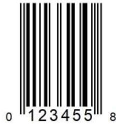
Abbildung 5.2.2.4-1. UPC-E Strichcode (Verschlüsselung von "012345000058" durch Nullunterdrückung)
