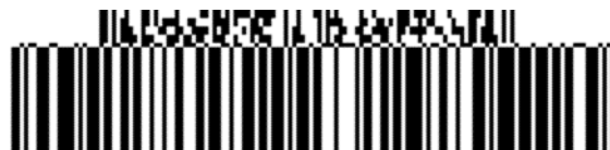
Abbildung 5.11.8-9. GS1-128 Symbol mit einer 4 spaltigen CC-A Komponente
