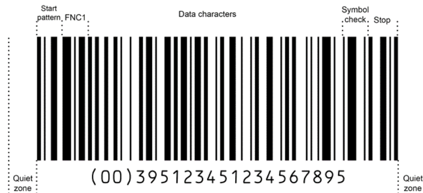
Abbildung 5.4.2-1. Allgemeines Format eines GS1-128 Strichcodes
