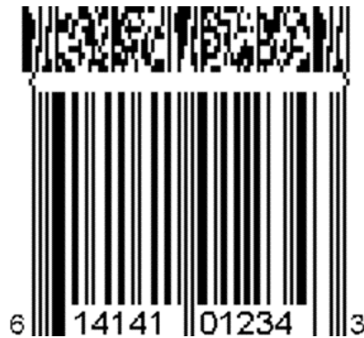
Abbildung 5.11.8-3. EAN-8 Symbol mit einer 3-spaltigen CC-A Komponente
