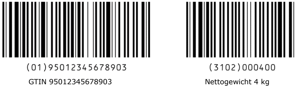
Abbildung 7.8.6.1-1. In zwei GS1-128 Symbolen verschlüsselte Daten
