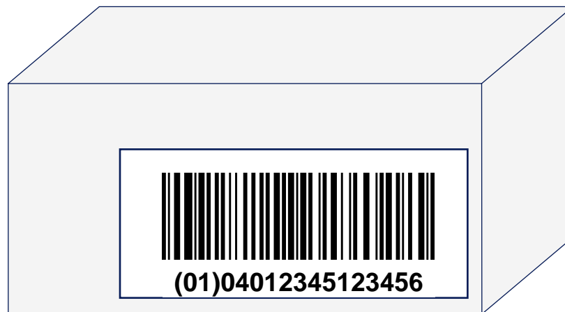
Abb. 18: Die GTIN-Artikelnummer im GS1-128-Strichcodestandard
