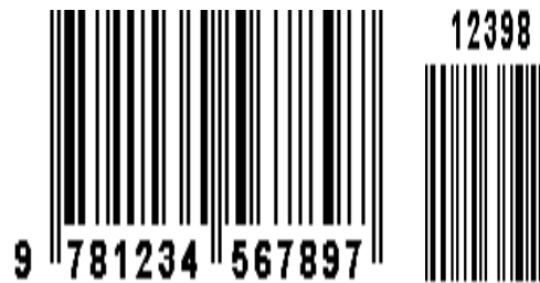
Abb. 7: Beispiel einer ISBN mit 5-stelligem Add-on im EAN-13-Strichcode
