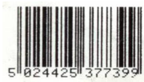
Abbildung 5.10.5.12-1. Symbol mit Problemen bei der Kantenvermessung
