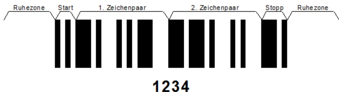
Abbildung 5.3.2.1.2-2. ITF-14 Symbol einschließlich der Ruhezeiten
