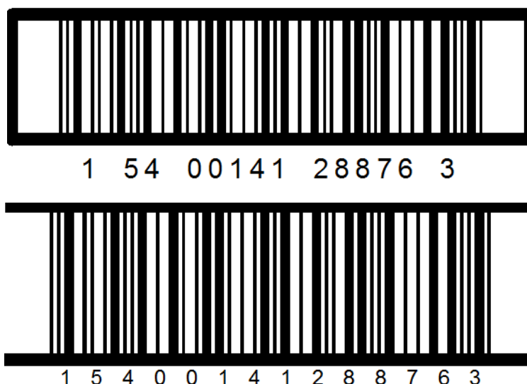
Abbildung 5.3.2.4-1. Beispiele von Trägerbalken
