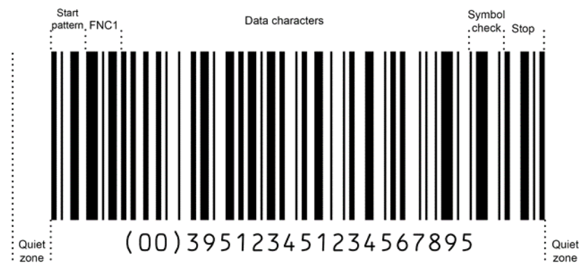
Abbildung 5.4.2-1. Allgemeines Format eines GS1-128 Strichcodes
