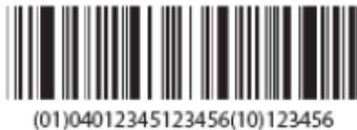
**Abbildung 2: GS1 DataBar Expanded**
