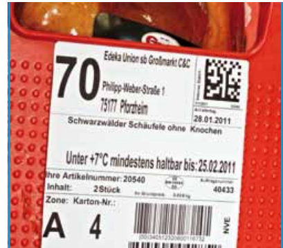
Verwechslung ausgeschlossen: Jede E2-Kiste erhält ein Transportetikett mit der Nummer der Versandeinheit NVE (SSCC).
