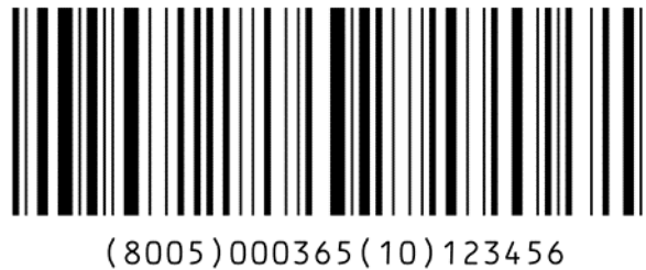
Abbildung 7-12 In einem GS1-128 Symbol verkettete Daten
