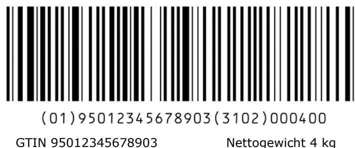
Abbildung 7-10 In einem GS1-128 Symbol verkettete Daten
