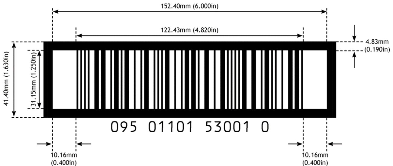
Abbildung 5-33 ITF-14 Symbol: Abmessungen bei einer X-Modulbreite von 1,016 mm (Nominalgröße) (0.040 in.)
