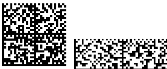
Abbildung 5-51 Unterteilte GS1 Data Matrix Symbole: quadratische und rechteckige Formate
