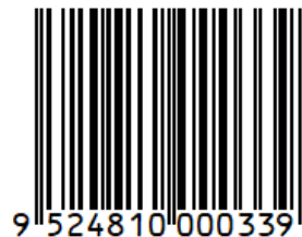
Abbildung 4-12 Beispiel eines EAN-13 mit Klarschriftzeile
