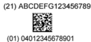
**Abbildung 22: GTIN im GS1 DataMatrix**
