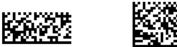
Abb. 5-2: Rechteckiges und quadratisches (GS1) DataMatrix-Symbol. Beide Symbole enthalten dieselben Daten.
