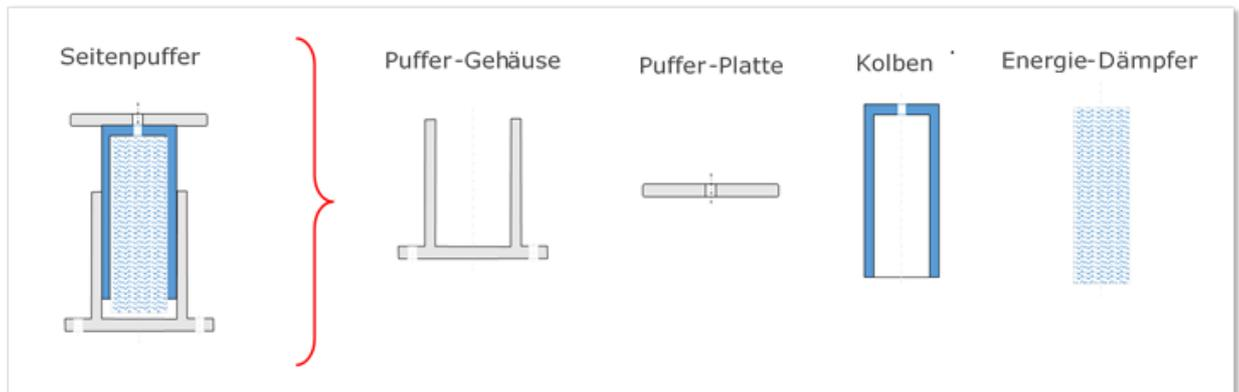
Das Beispiel zeigt einen Seitenpuffer, der ein aus vier Bauteilen zusammengesetztes MRO-Objekt ist (Puffer-Gehäuse, Puffer-Platte, Kolben und Energiedämpfer). Das Puffergehäuse ist das führende Teil.
