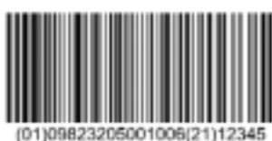
Abb. 1: Personalisierter Coupon-Barcode auf Basis EAN 128
