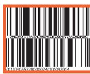
GTIN und Chargennummer: Auch bei der Codierung von GTIN und Chargennummer benötigt der GS1 DataBar Expanded nur etwa den gleichen Platz (oranjer Kasten) wie ein EAN-13-Strichcode (graue Fläche), der lediglich die GTIN beinhaltet.
