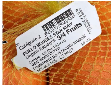
Abbildung 3 - 13: Beispiel für Scanningprobleme wegen mangelnder Höhe des Barcodes
