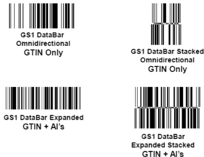
Abbildung 3 - 3: GS1 DataBar Symbole, die am POS verwendet werden
